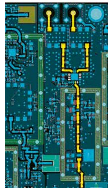
Пример СВЧ-платы, содержащей приемные и передающие тракты цифрового телевидения и управляющий микроконтроллер.
