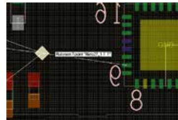
Возможность задавать порядок трассировки выводов в цепи и выравнивать «плечи» цепи позволяет трассировать скоростные интерфейсы
