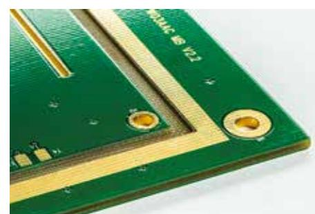
Фрезеровка на заданную глубину
