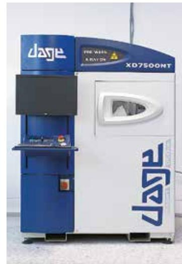
Качество монтажа свинцовых и бессвинцовых BGA-компонентов подтверждается проверкой на установке рентген-контроля
