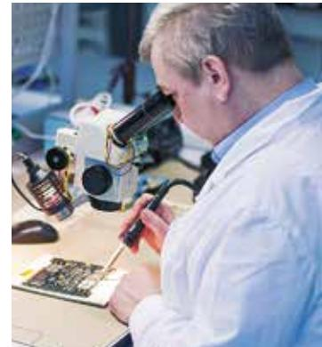
Визуальный контроль качества и корректировка микропаяльником дополняют автоматизированный контроль качества на системе АОИ
