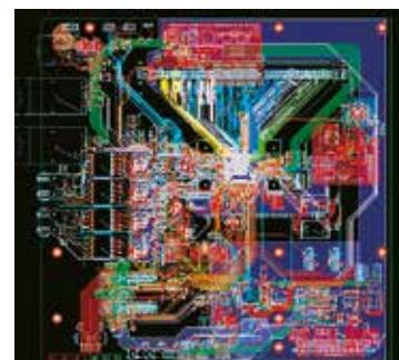
Пример печатной платы с трассировкой интерфейса DDR3 на планки памяти, с выравниванием байтов данных и шины адреса и управления
