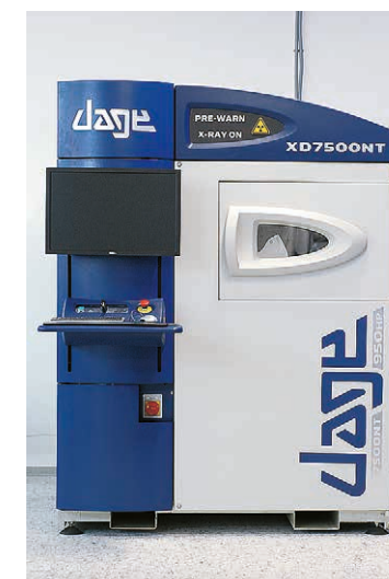
Качество монтажа свинцовых и бессвинцовых BGA-компонентов подтверждается проверкой на установке рентген-контроля
