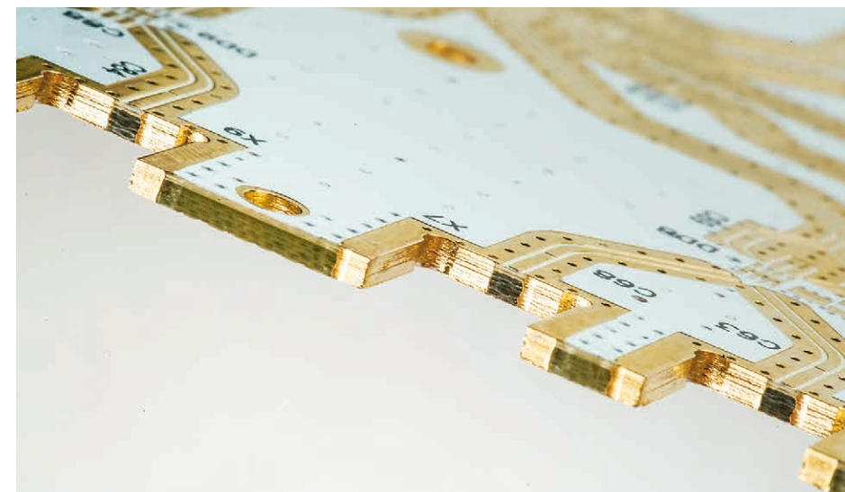
Композитная МПП, верхний слой Ro4003, металлизация торца
