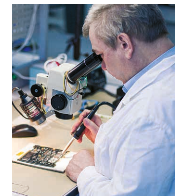
Визуальный контроль качества и корректировка микропаяльником дополняют автоматизированный контроль качества на системе АОИ
