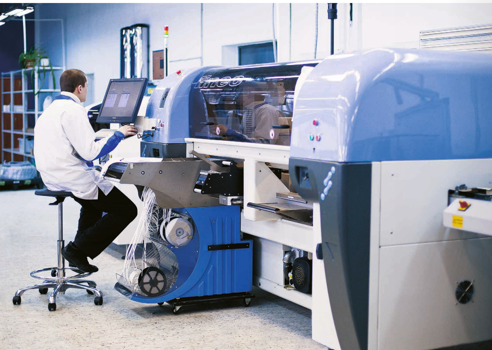
Станок SMT-монтажа Europlacer IINEO Tornado позволяет зарядить одновременно до 250 номиналов
